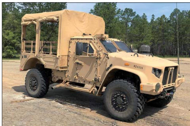
■ Dvoudveřová logistická verze uveze až 2313 kg nákladu. Na snímku během zkoušek s doplňkovou sadou lavic a plachtou, jimiž lze osadit korbu a uzpůsobit ji pro přepravu vojáků mimo bojovou zónu.
